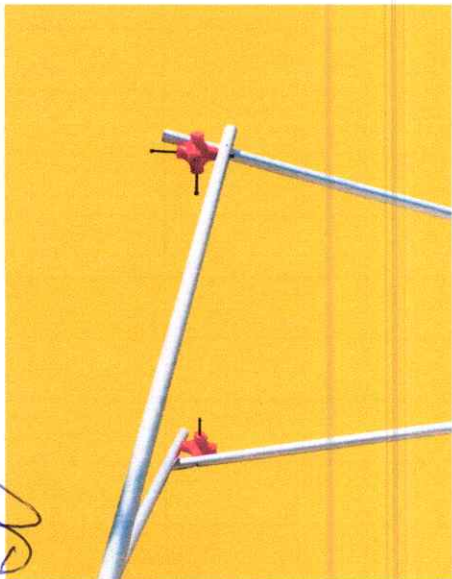
Figure 11.3 Prototipo de estructura desplegable con impresión 3D escala 1 en 1 Fuente: Elaborado por el autor
