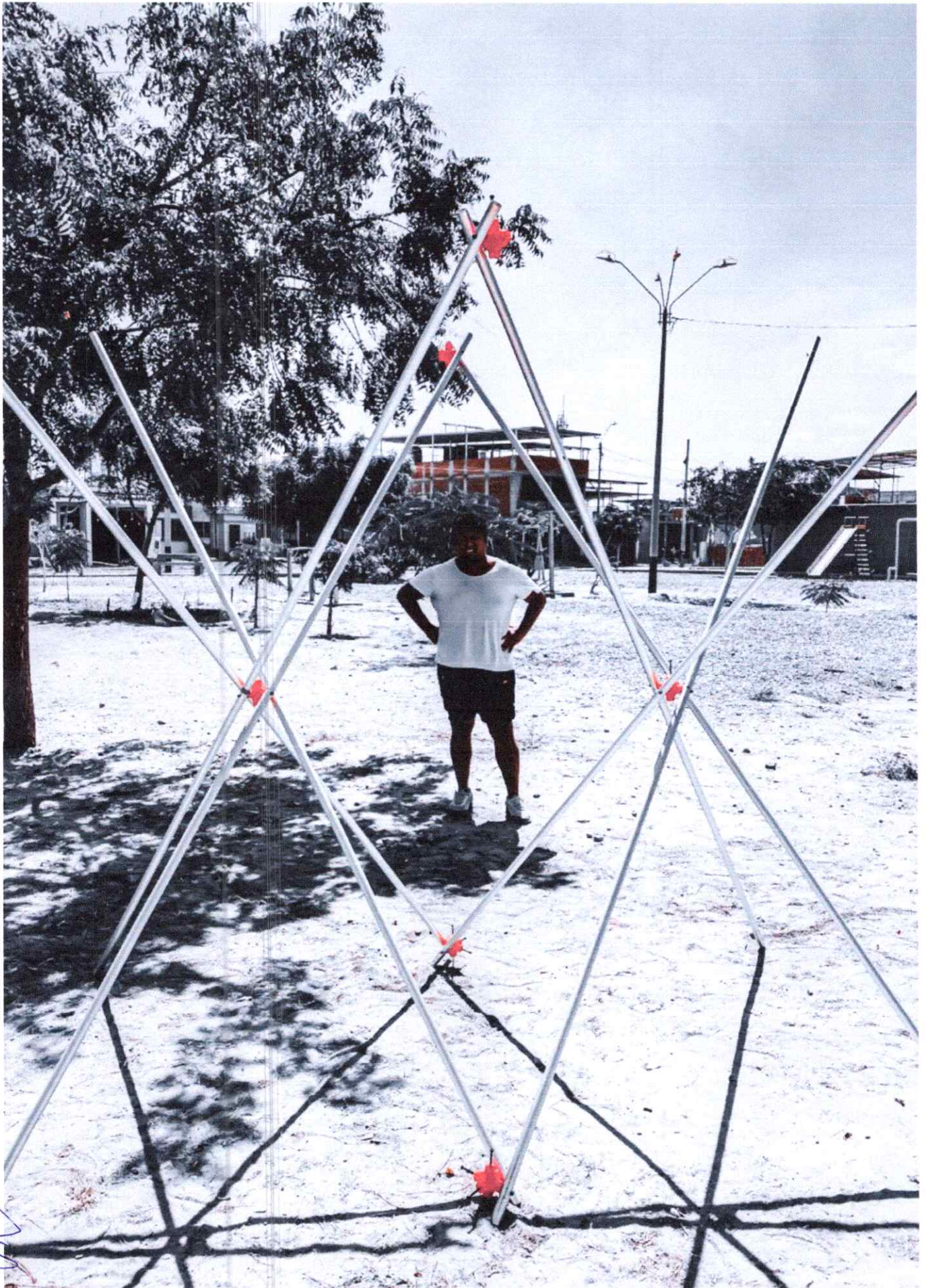
Figure 13. Prototipo de estructura desplegable con impresión 3D escala 1 en 1 Fuente: Elaborado por el autor
