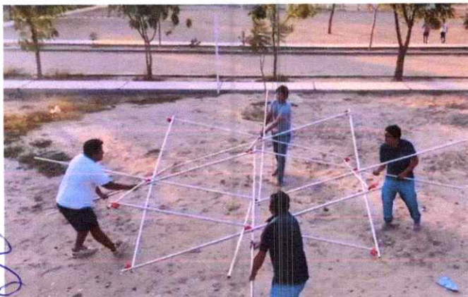
Figure 10.1. Abertura máxima de módulos de prototipo de estructura desplegable con impresión 3d escala 1 en 1. Fuente: Elaborado por el autor
