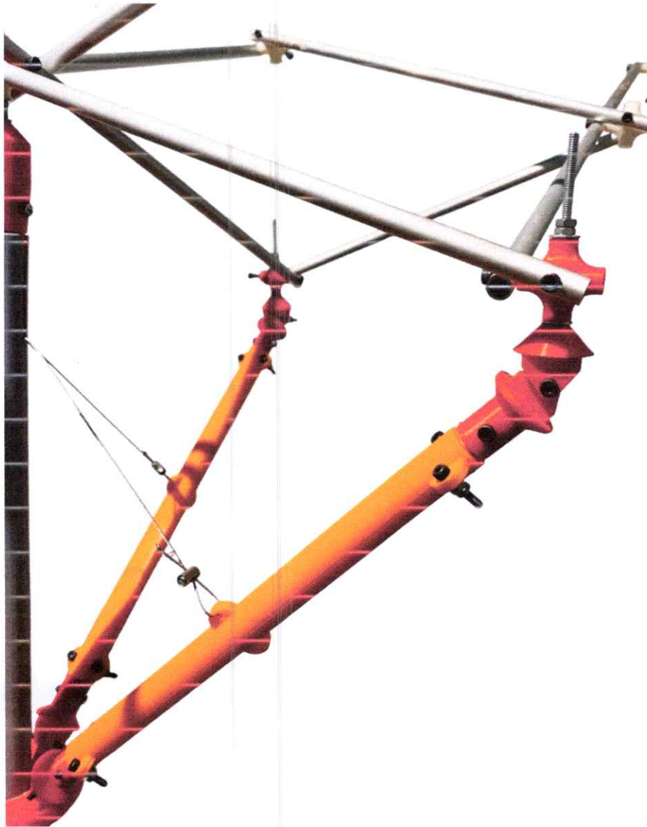
Figure 5. Prototipo de estructura desplegable escala 1 en 1 Fuente: Elaborado por el autor
