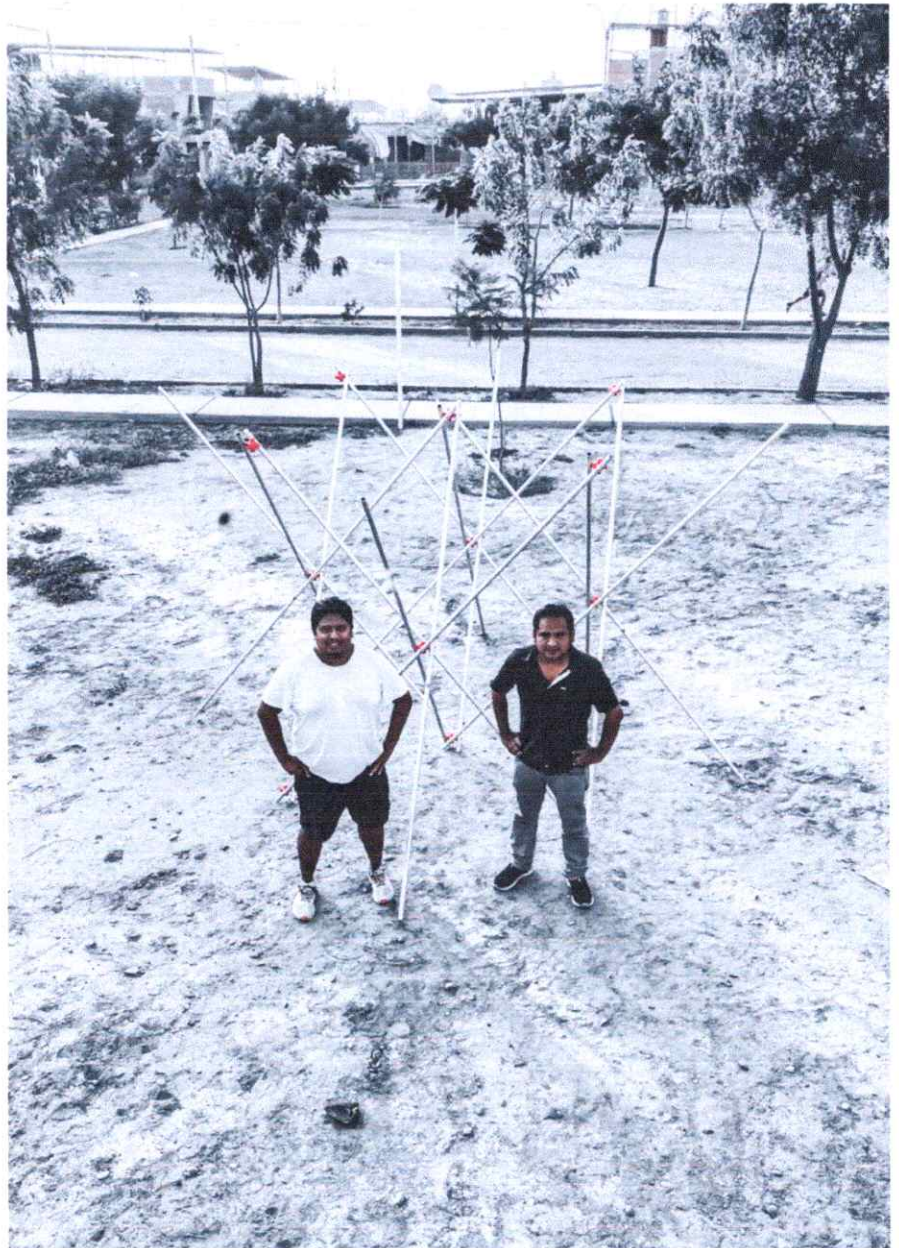
Figure 12. Prototipo de estructura desplegable con impresión 3D escala 1 en 1 Fuente: Elaborado por el autor
