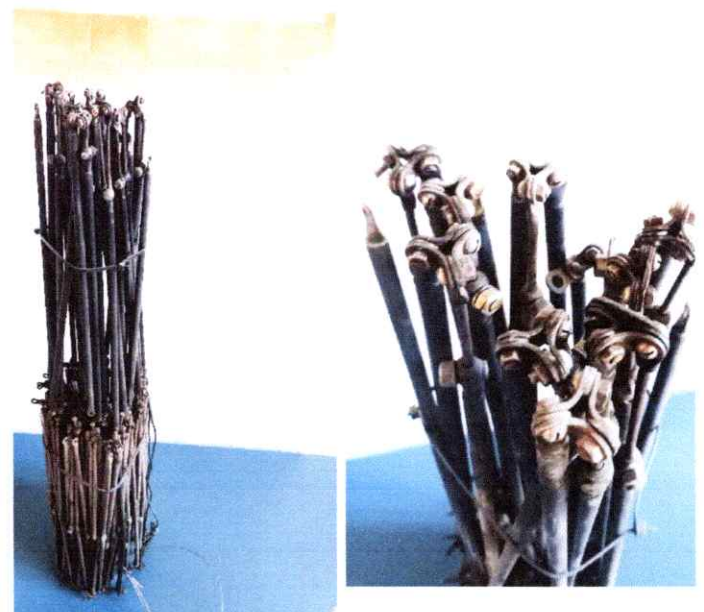
Figura 8.0. Cúpula reticular desplegable para grandes luces, prototipo conservado en la Fundación Emilio Pérez Piñero, Calasparra, España. Fuente: Imagen tomada por el autor.
