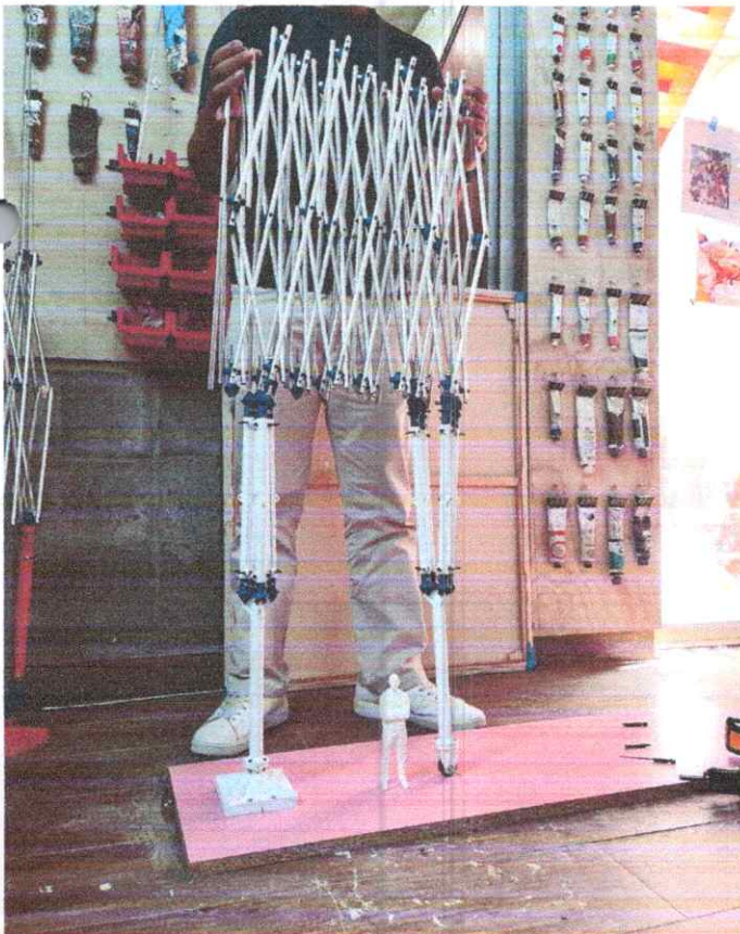
Figura 13.0. Prueba de despliegue de la estructura de un módulo lineal Fuente: Elaborado por el autor
