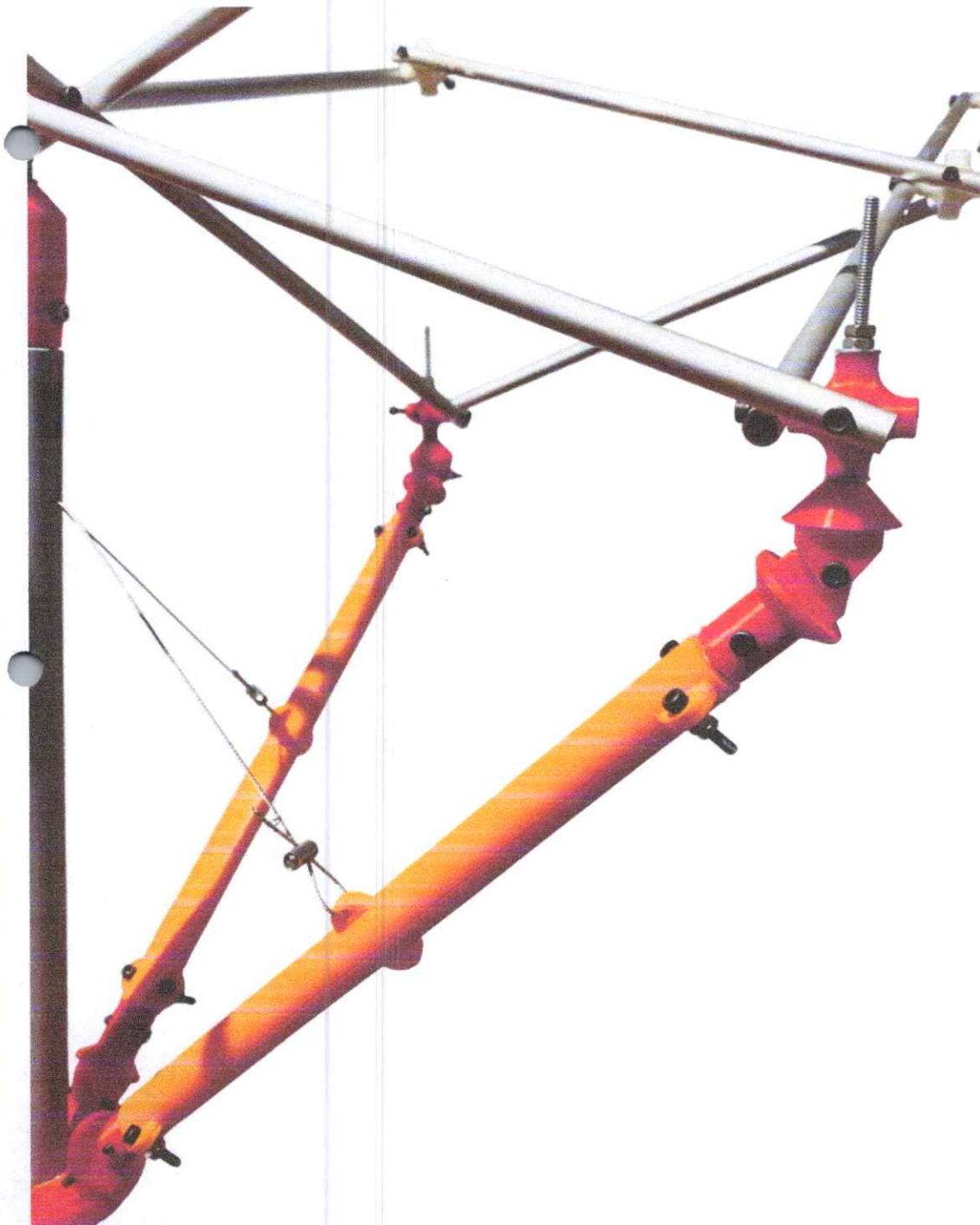
Figure 8.0. Prototipo de estructura desplegable escala 1 en 1 Fuente: Elaborado por el autor
