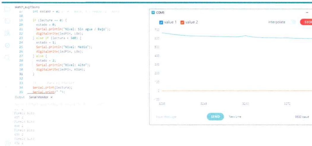
Fig. 01. Ejecución cuando el sensor está dentro del agua nivel alto
